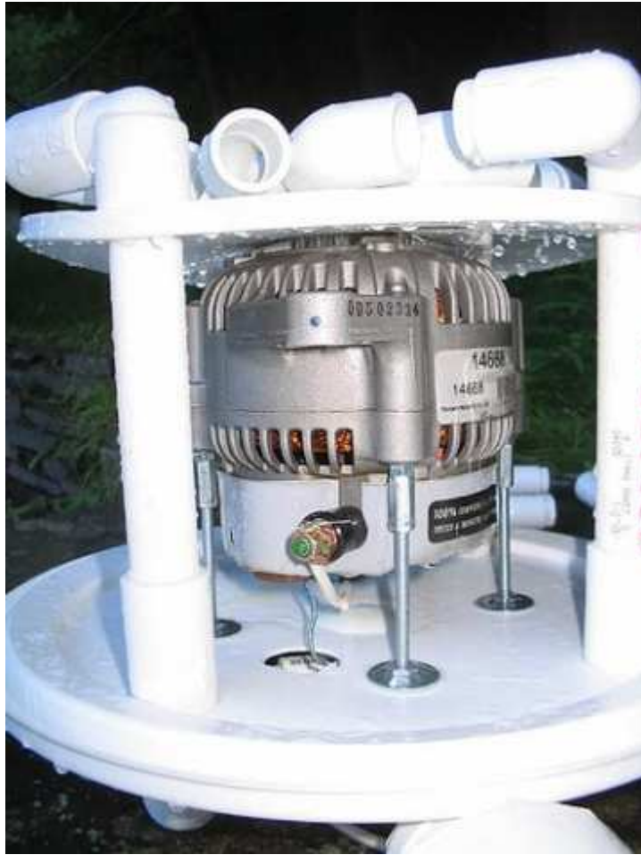
Vista interna: Alternador de imanes permanentes. Imagen: AIDG
